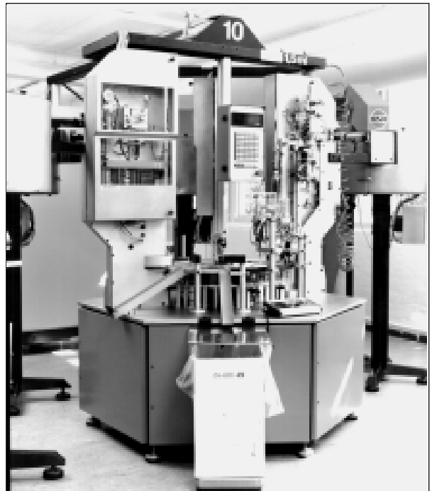
"NovoLet" assembly system at Novo Nordisk in Værløse.
